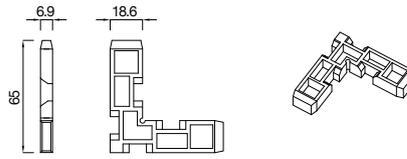
4484069 Raccord d'angle moulé sous pression, 6,9 mm d'épaisseur
