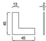
**4485132** Raccord d'angle aluminium 13 mm, 2,0mm d'épaisseur
