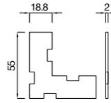
**4485020** Raccord d'angle aluminium, 2,0 mm d'épaisseur
