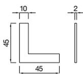
**4485102** Raccord d'angle aluminium 10 mm, 2mm d'épaisseur
