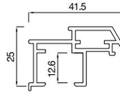
**2153541** Profilé de châssis ouvrant 41mm ,aligné FB12
