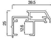
**2153539** Profilé de châssis ouvrant 39,5 mm ,aligné FB12
