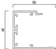
2185045 Profilé de recouvrement pour système de jonction 45 x 50 mm
