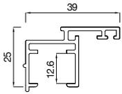
**2153939** Profilé de châssis ouvrant 39mm ,aligné FB5
