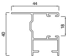
**2184044** Profilé de guidage de volet roulant 44 x 40 mm
