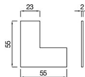
**4485232** Raccord d'angle aluminium 23 mm, 2 mm d'épaisseur
