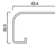
**2184430** Profilé pour le déroulement du volet roulant 43,4 x 30,5 mm
