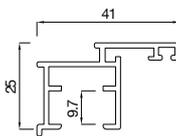
**2153641** Profilé de châssis ouvrant 41 mm ,aligné FB5
