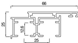
**2153666** Profilé de châssis ouvrant 66 mm ,aligné FB5
