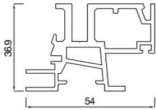
2183754 Profilé de base pour système de jonction 54 mm
