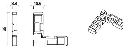
4484088 Raccord d'angle moulé sous pression, 8,8 mm d'épaisseur
