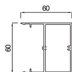
2126060 Profilé de recouvrement 60 mm, 60 mm
