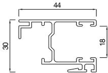
**2184344** Profilé de guidage de volet roulant 44 x 30 mm
