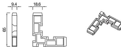
4484094 Raccord d'angle moulé sous pression, 9,4 mm d'épaisseur
