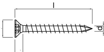
Tête  $\varnothing d_k=8\text{mm}/10\text{mm}$
