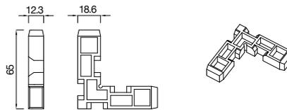
4484123 Raccord d'angle moulé sous pression, 12,3 mm d'épaisseur
