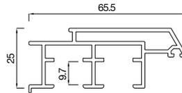
**2153165** Profilé de châssis ouvrant 65,mm ,aligné FB12
