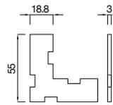
**4485030** Raccord d'angle aluminium, 3,0 mm d'épaisseur
