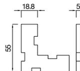
**4485050** Raccord d'angle aluminium, 5,0 mm d'épaisseur
