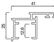
**2153941** Profilé de châssis ouvrant 41 mm ,aligné FB5
