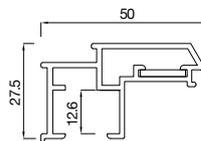
**2153550** Profilé de châssis ouvrant 50 mm ,aligné FB12
