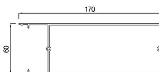
2821760 Profilé de recouvrement 60 mm, 170 mm
