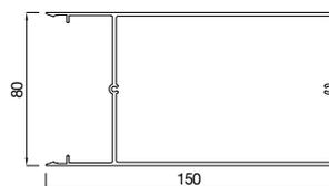
2821580 Profilé de recouvrement 80 mm, 150 mm
