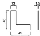
**4485131** Raccord d'angle aluminium 13 mm, 1,5mm d'épaisseur
