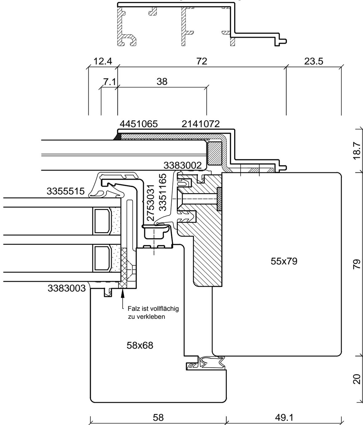
Brüstungsscheibe aus VSG (ESG 6 mm / PVB / ESG 6 mm)
