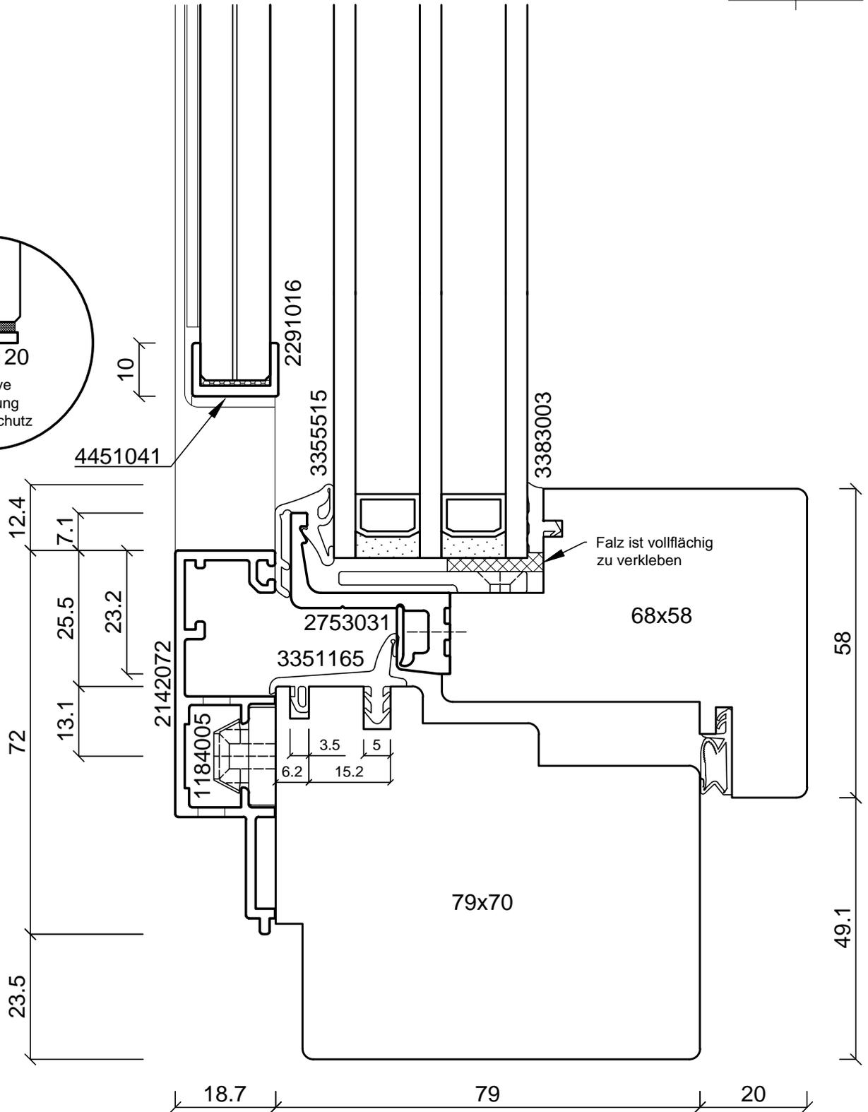
Brüstungsscheibe aus VSG (ESG 6 mm / PVB / ESG 6 mm)
