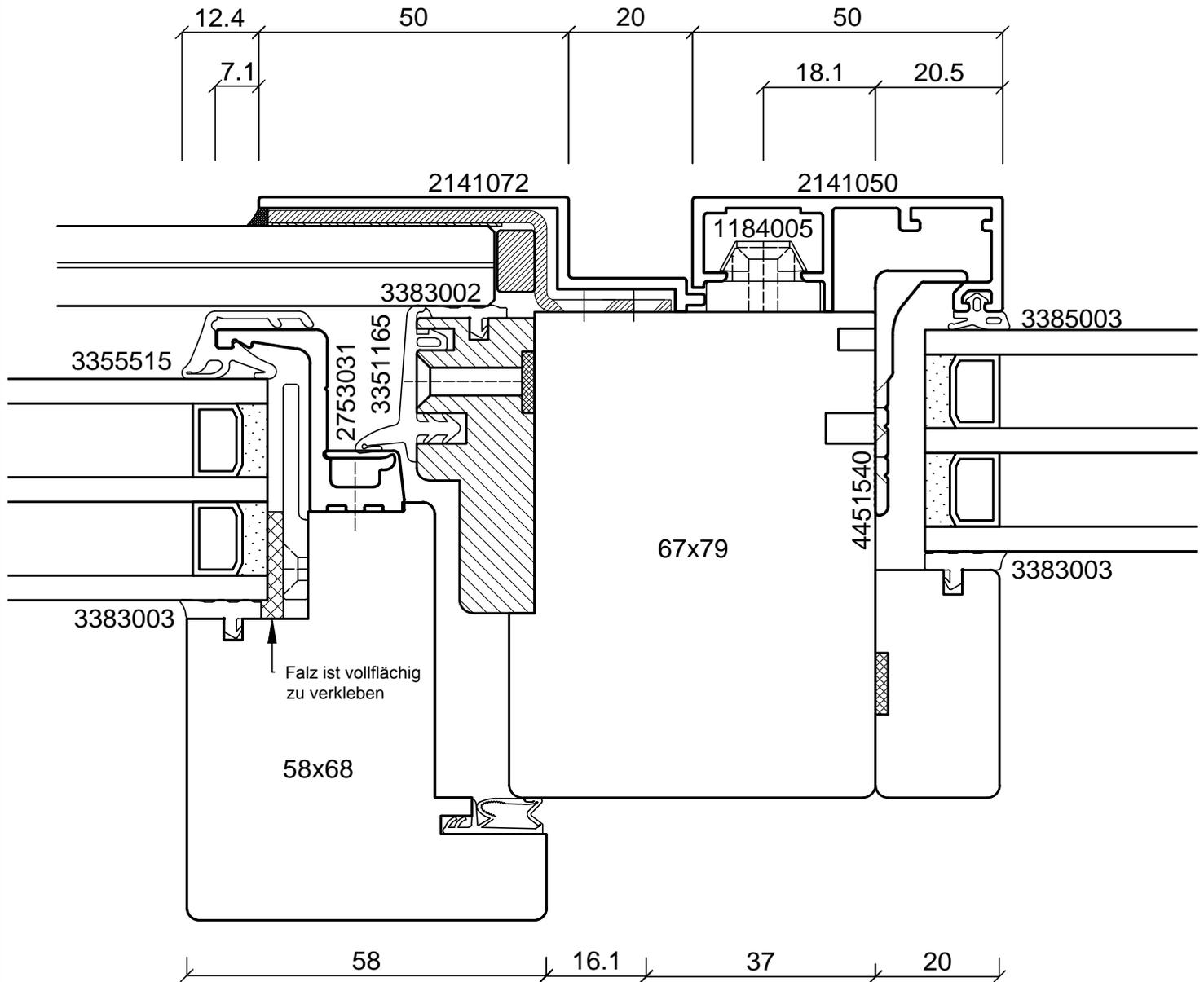
Brüstungsscheibe aus VSG (ESG 6 mm / PVB / ESG 6 mm)
